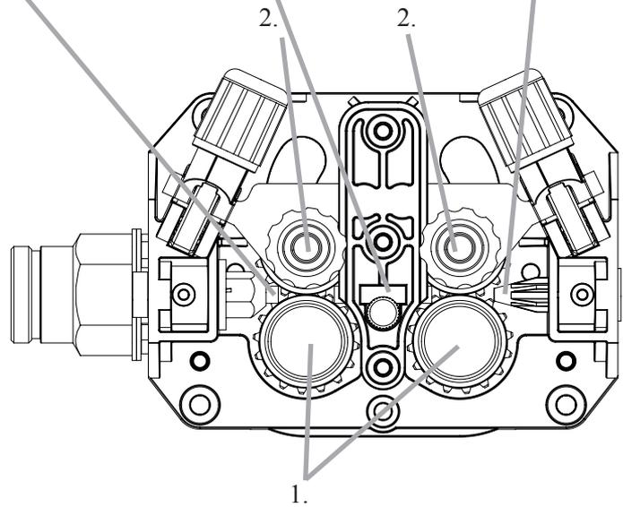
1 = Приводной ролик, 2 = Прижимной ролик
