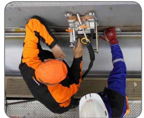
Настройку выполнить несложно, а все регулировки параметров сварки выполняются на тракторе, что сокращает время настройки и облегчает дистанционное управление.
