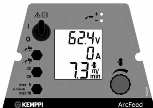
В режиме CV на дисплее отображается напряжение сварки и скорость подачи проволоки (WFS). Диапазон регулировки скорости подачи проволоки зависит от размера проволокоподающего ролика. С маленьким роликом скорость составляет 0–18 м/мин, с большим роликом она может составлять 0–25 м/мин.
